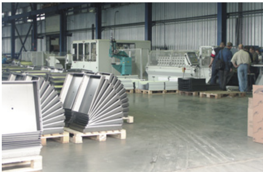
Автоматизированный комплекс изготовления корпусов светильников исключает ручной труд при раскрое заготовки и формировании корпуса наиболее массовых видов светильников. Разработка инженеров завода светильников «ЛЮМСВЕТ» защищена патентом
